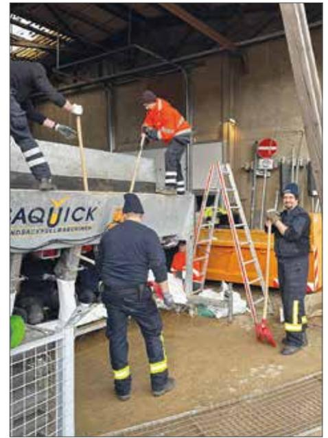
Die Sandsäcke werden am Einsatzort abgeladen und als Schutz gestapelt. Nach dem Einsatz wird die Füllmaschine entleert.
