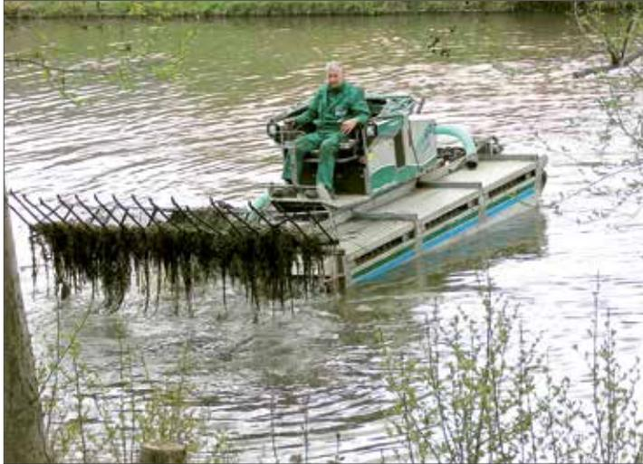
Mit einem Amphibienfahrzeug werden Unrat und abgestorbene Pflanzenteile gesammelt, bevor die Entschlammung beginnen kann.
